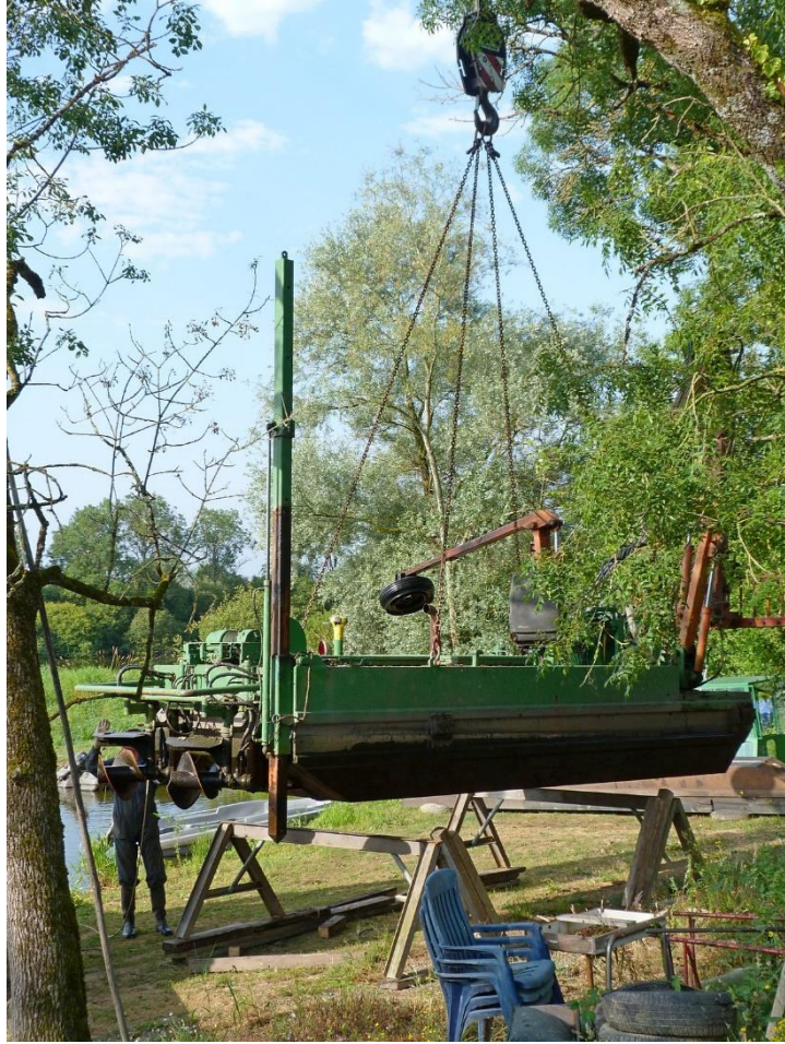
Figure 26 : Sortie de l'eau de la pelle flottante pour carénage
