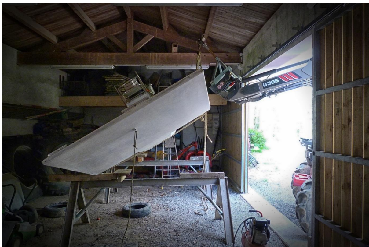
Figure 16 : Carénage de la coque de l'hydroglisseur
