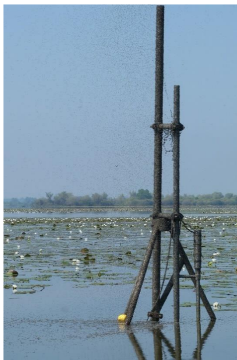
FIGURE 20 : CANNE DE TURBIDITE EN PLACE SUR SON SUPPORT AU SEIN DU LAC (MAI 2018)
