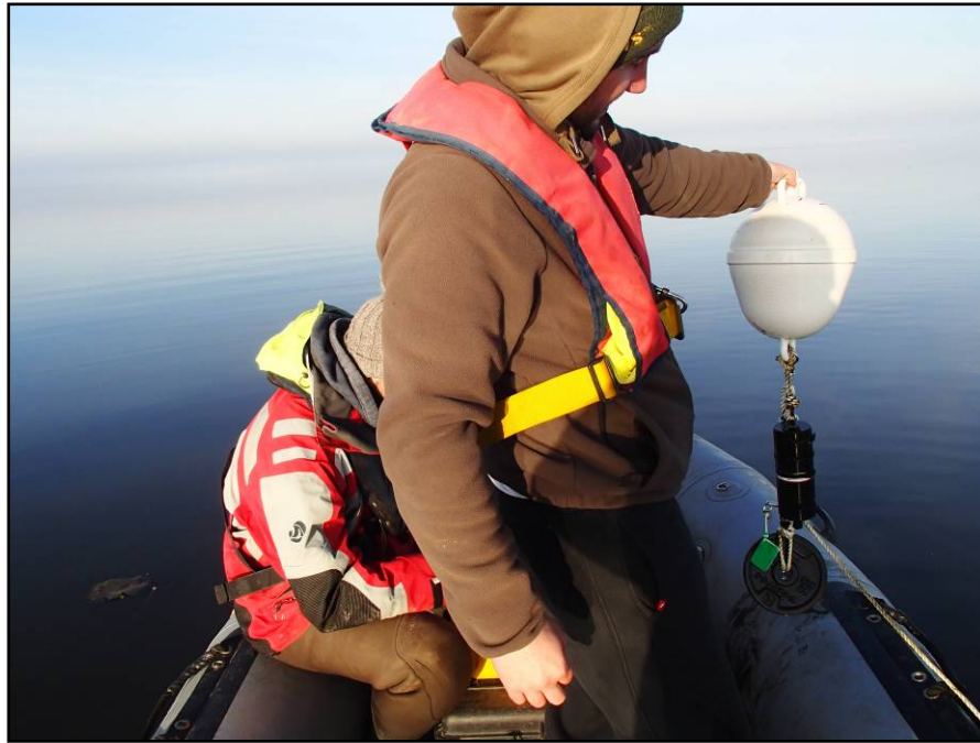
Figure 119 : Photo du système de fixation d'un hydrophone sur le lac
