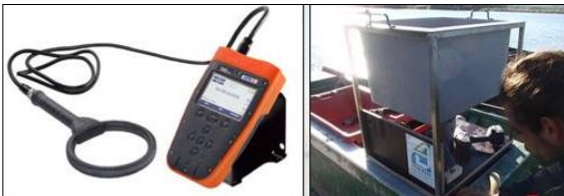
Figure 38 : Photographies représentant, à gauche le lecteur PIT-tag et à droite le dispositif mis en place sur les bateaux pour cette étude. (FISH PASS)
