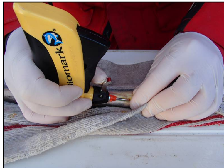
Figure 39 : Lecteur enregistreur de PIT TAG et injection de PIT TAG (FISH PASS)
