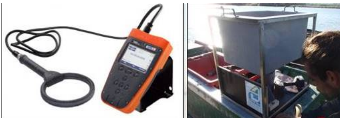
Figure 30 : Photographies représentant, à gauche le lecteur PIT-tag et à droite le dispositif mise en place sur les bateaux pour cette étude. (FISH PASS)
