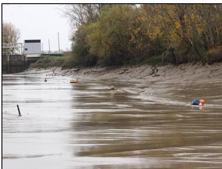
Figure 81 : Vue des bouées des corps morts sur lesquels sont fixés les hydrophones à marée basse (FISH PASS). Hors d'eau, les hydrophones ont peu de chance de capter des signaux acoustiques.
