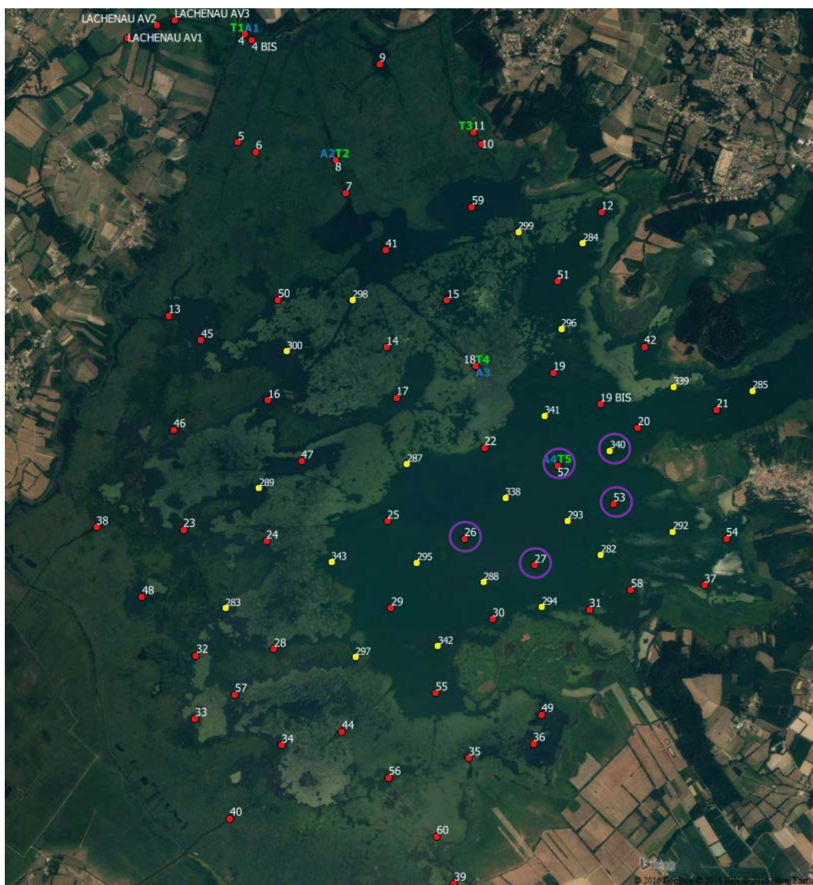
Figure 84 : Position des 80 hydrophones installés sur le lac de Grand Lieu et des 3 hydrophones directement en aval du lac (rouge : Hydrophone classique ; jaune : hydrophone avec une sonde température intégrée, vert : capteur T° supplémentaire, bleu : accéléromètre, violet : zone de relâche) en Septembre 2016
