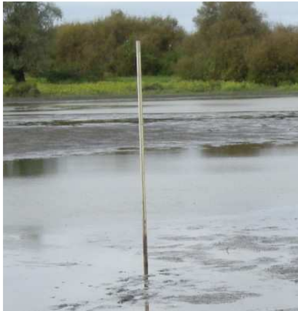
Figure 15 : Règle graduée permettant la relève régulière de la hauteur d'eau sur les prairies des Bonhommes.
