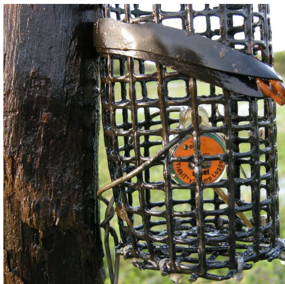
Figure 17 : Sonde de mesure de la température de l'eau posée sur les prairies des Bonhommes
