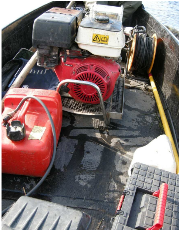
Figure 27 : Groupe électrogène utilisé pour délivrer un courant électrique durant la pêche.
